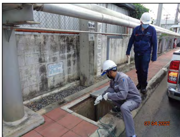
รูปที่ 3.9 การเก็บตัวอย่างน้ำ บริเวณจุดปล่อยน้ำทิ้งจุดที่ 2 จากโครงการเข้าสู่ระบบรวบรวมน้ำเสียของสวนอุตสาหกรรมเครือสหพัฒน์-ศรีราชา
